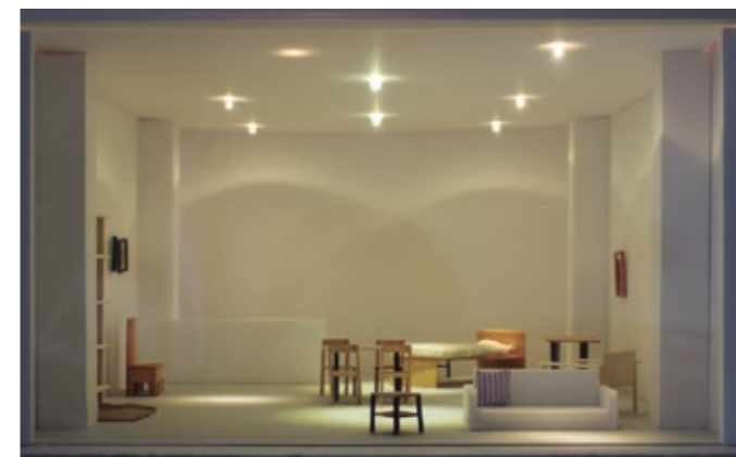
▲図1 模型の点灯写真(左:一般的な上から照らしたもの、右:壁面を照らして省エネかつ明るく見せる手法)。
