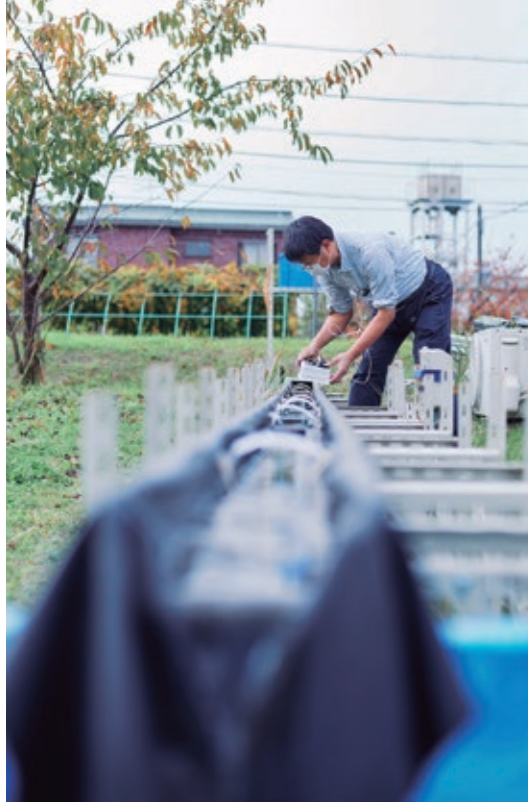
(左) 下水の終末処理場の敷地内に設置した実験装置 (右上) 管路内にスポンジ状の浄化材料を敷き詰める (右下) 千葉県市川市にある菅野終末処理場
