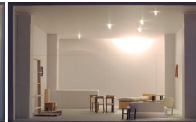
▲図1 模型の点灯写真(左:一般的な上から照らしたもの、右:壁面を照らして省エネかつ明るく見せる手法)。
