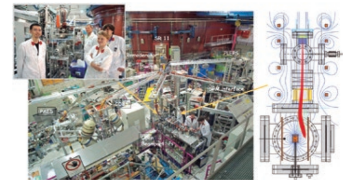
▲図4 原子炉を利用した大強度陽電子源(ミュンヘン工科大学NEPOMUC)での実験風景と、トラップ装置への陽電子ビーム入射の模式図。
