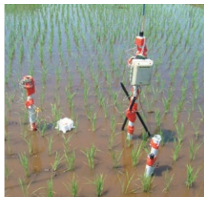
データロガー(左)および水位・水温センサー(右)
