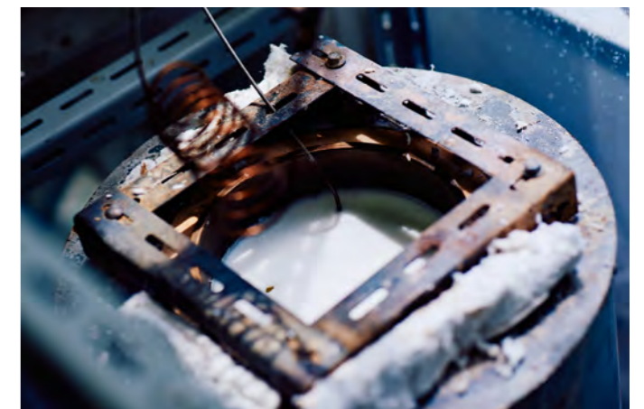
▼内容積10mL程度のステンレス製リアクターを用いて実験しています。
