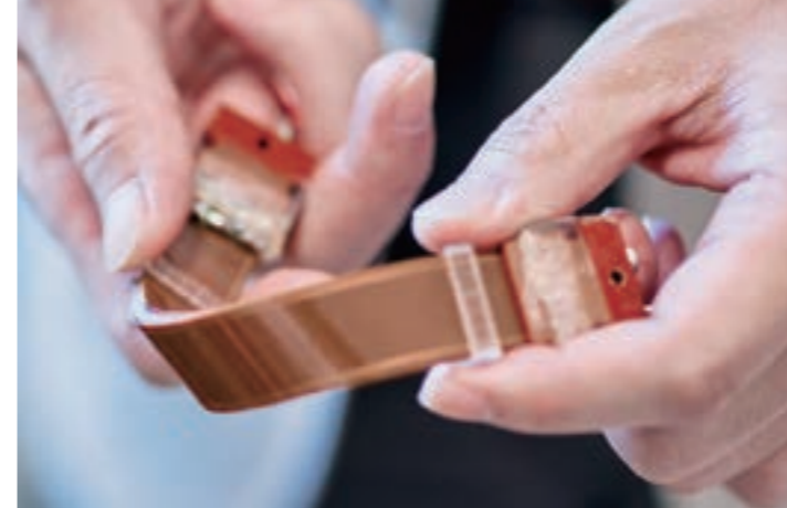
▲図1 柔軟な静電フィルムアクチュエータ。高電圧の駆動電圧を印加すると全体が伸縮動作を行う。実際の駆動は柔軟なパッケージに絶縁液と一緒に封止した状態で行う。
