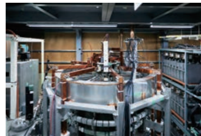
球状トカマクプラズマ合体実験装置UTST(上部)
