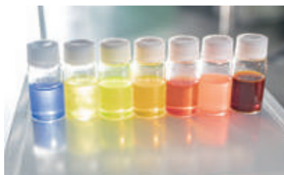
図1:パイ共役系有機化合物のインク。分子構造によって、バンドギャップが異なるため様々な色のインクが得られる。
