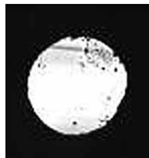
図1: \text{Ni}_2\text{InSbO}_6 結晶のキラルドメイン分布の偏光顕微鏡イメージング像
