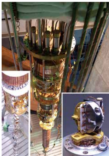
図1：物性研の核断熱消磁冷凍機。 超低温（1 mK）・高磁場（10 T）の実験が可能
