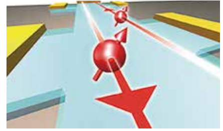
量子ホール効果におけるエネルギー散逸のないエッジ状態の模式図
