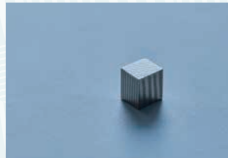
▲内田教授がNIMSで開発した熱電永久磁石(人工傾斜型多層積層体)。永久磁石でありながら、電流を流すと電流と直交した方向に熱流が流れて片面を冷却したり、温度差を与えることで発電したりすることができる。
